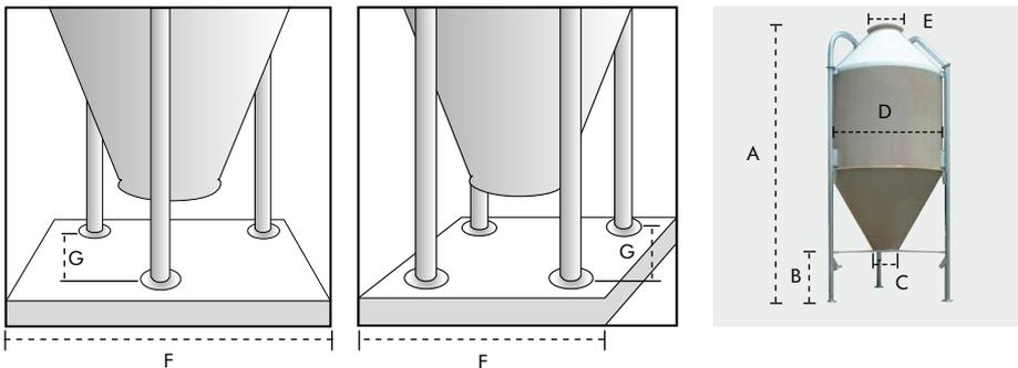
Die Glasfasersilos werden aus hochwertigem Kunststoff hergestellt. Alle verwendeten Metallteile sind feuerverzinkt und garantieren eine lange Lebensdauer.
